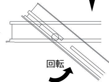
✕ 施工後や点検の際は点検口枠の上に乗らないでください。乗ると枠が壊れます。
